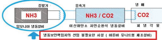
[그림 2] NH 3 /CO 2 2차 냉매 시스템(2004년에 냉동 보안 규칙에 규정)
