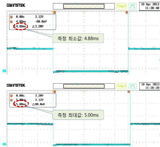
그림 4. 측정된 최대 시간과 최소 시간 Fig. 4. The Maximum and Minimum Time Measured
