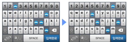
(그림 2) 보안 키패드의 무작위 배열 (Figure 2) Random Layout of a Secure Keypad
