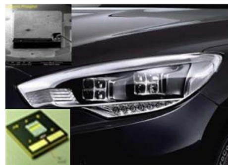
Fig. 8. 기아자동차 K9의 헤드램프에 장착된 플레이트 형광체 기반 LED.
