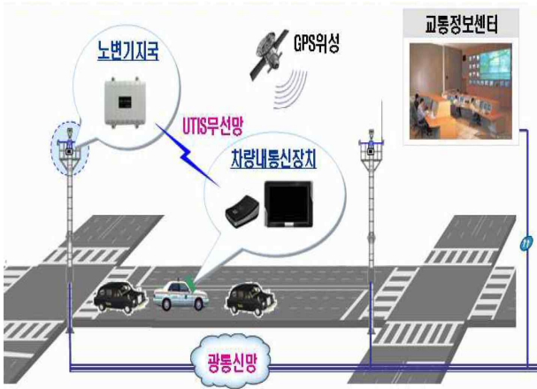
〈Figure 4〉 Configuring UTIS communication system.
