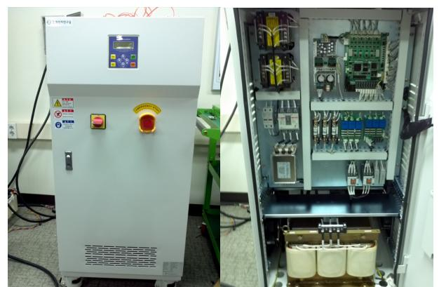
Fig. 20. The PV simulator
