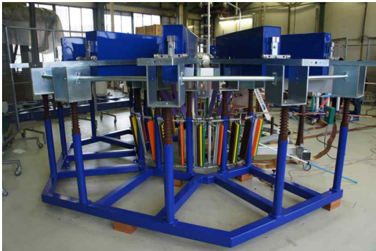
그림 8. 임펄스전류발생기(10/350 \mu s, 200kA)
