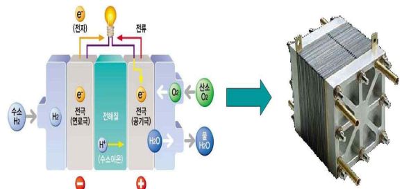
그림 3. 연료전지 원리 및 스택구조
