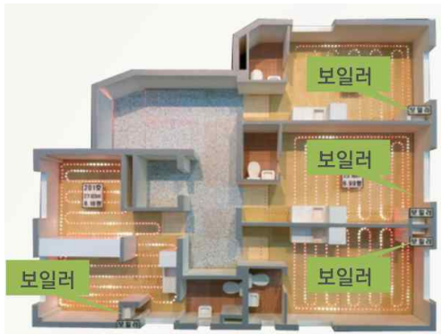
난방, 급탕 겸용 보일러 개별 4대 설치
