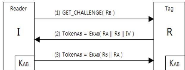
그림 3. RFID 리더와 태그간의 3단계 상호인증 절차
