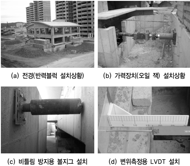
그림 8. 실험체 설치 및 가력상황 사진
