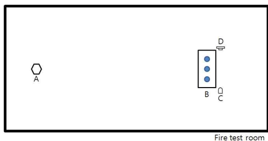
A : Test fire B : Test panel C : Lamp Assembly D : Photocell assembly
