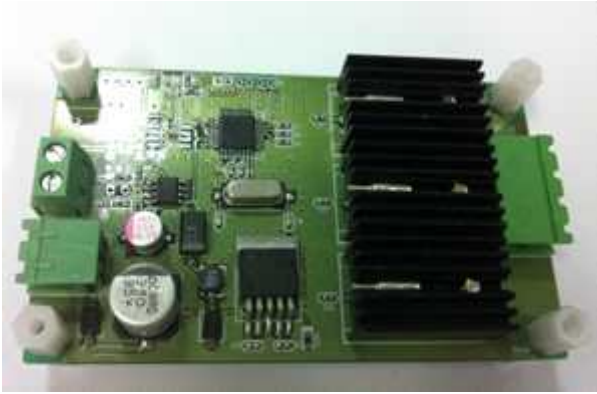
그림 2. 실험에 사용한 조명 컨트롤러 Fig. 2. Lighting controller used in the experiment
