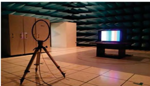
그림 1. PDP TV의 방사 측정 Fig. 1. Radiation measurement of PDP TV
