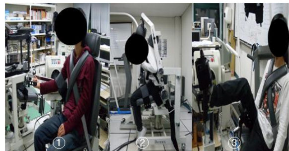
그림 6. 근력증진효과 분석을 위한 관절토크 측정 (①팔꿈치관절, ②요추관절, ③발목관절)
