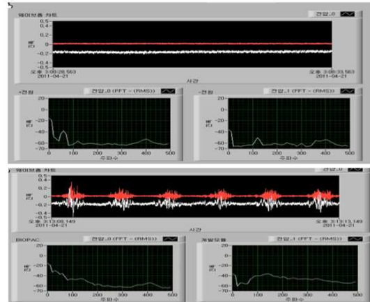
그림 4. 제작모듈과 상용기기의 근전도 신호비교를 위해 근육에 힘을 안준 평상시(상) 신호와 힘을 주는 동작 중(하)일 때 획득된 근전도신호의 시간영역 및 주파수영역의 특성비교
