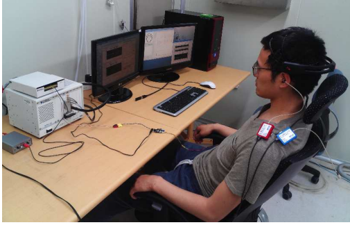
그림 6. 구현된 gap prepulse 기반의 소리 자극에 의한 청성 후기 반응 측정 시스템을 이용한 실제 측정 모습
