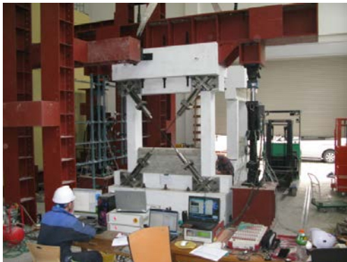
Fig. 4 실험체 설치장치 및 측정장치
