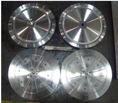
Fig. 7. Diffusers production die
