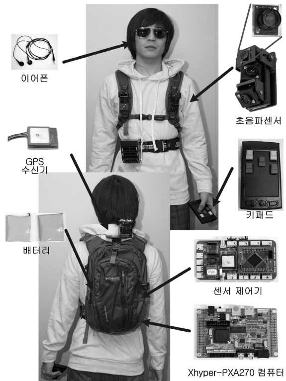
그림 3. 6개의 초음파 센서와 GPS 수신기를 이용한 보행지원 시스템의 시제품
