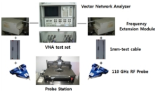
그림 9. W-대역 S-파라미터 측정 셋업 Fig. 9. W-band S-parameter measurement set-up.
