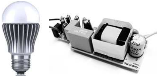
그림 11. PSR 방식 PWM 컨버터 Fig. 11. PSR type PWM converter
