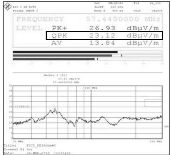
(a) EMI CE(Conduction Emission) 측정결과
