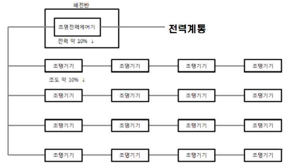
그림 3. 조명전력제어장치구성도 Fig. 3. The layout of lighting power control system
