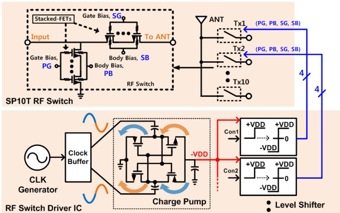
그림. 1. 클락 발생기, 전하펌프 및 레벨 시프터로 구성된 안테나 스위치 블록 다이어그램
