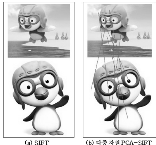
그림 3. 상표를 포함하지 않는 이미지에 대한 매칭 결과비교. Fig. 3. The comparison of matching result to an image without a product label.
