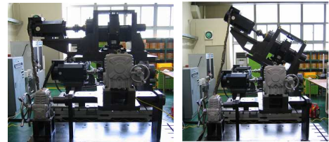
(d) Test jig for Bearing Test
