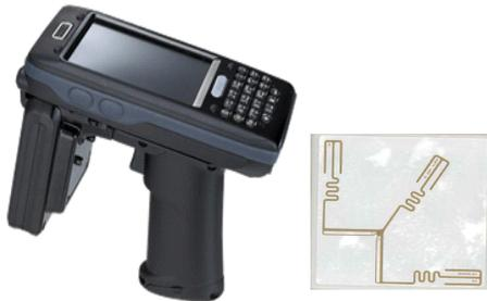
그림 3. RFID 단말기 및 태그
