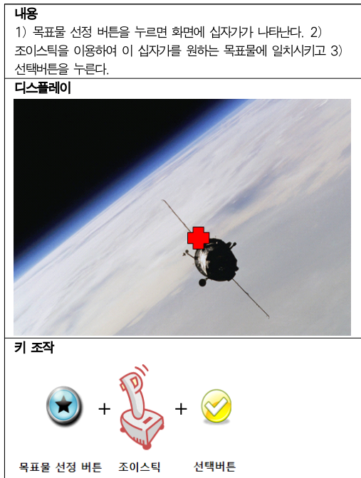
그림 4. 시스템 I을 나타내는 시뮬레이터 Fig 4. Simulator for System I
