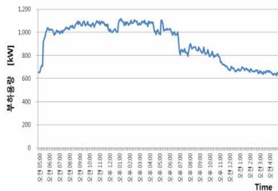
그림 1. 수용가 5분 단위 전력부하패턴 Fig. 1. The 5minute's load pattern for the building customer
