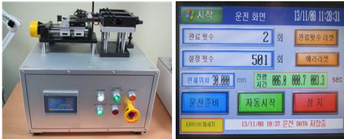
<그림 2> 스트립 삽입 추출 시험기 및 디스플레이
