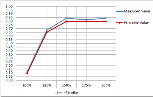
〈그림 8〉 우회도로 원할 상태 비교 그래프 〈Fig. 8〉 Comparison predictive value with measured diversion rate in free of traffic
