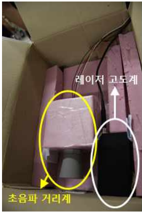
그림 9. 박스의 내부 Fig. 9. Inside of the Box
