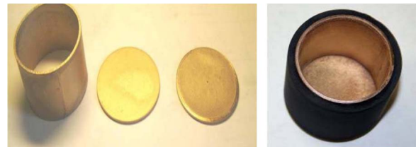
Fig. 3. AlN 단결정 성장용 TaC crucible 및 TaC in graphite jacket. 12)
