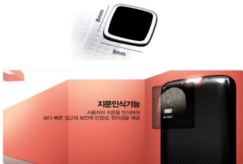
(그림 2) AuthenTec의 AES850 지문 센서와 이를 탑재한 Motorola의 ATRIX
