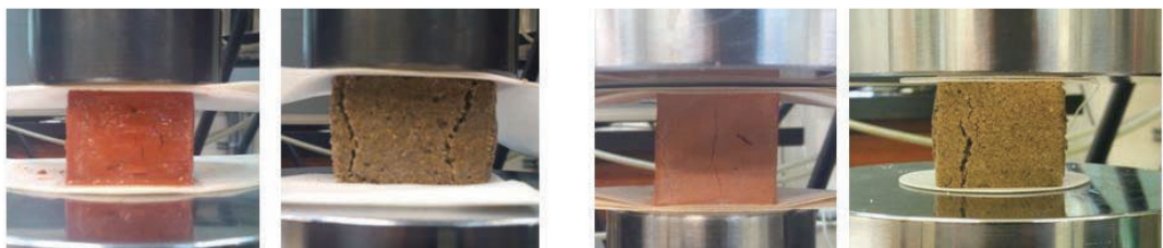
그림 8. 열적젤화 바이오폴리머 혼합 시편 제작 및 불구속일축압축강도 측정 예시
