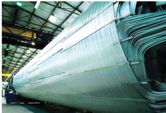
그림 7. Spiral wound type heat exchanger
