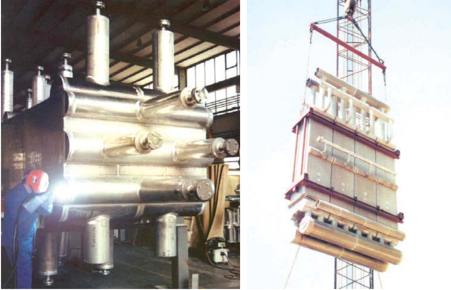
그림 8. 극저온용 플레이트 핀 열교환기 외형(좌), 콜드박스에 장착되고 있는 모습(우)
