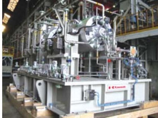
그림 8. Gas Turbine Compressor(Dresser-Rand社)
