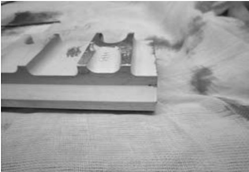
Wedge부위 Crack 발생
