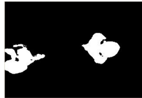
그림 2. Adaptive GMM을 이용한 움직이는 객체 추출
