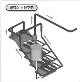
수냉식관을 이용한 냉각방식으로 상·하부가 뚫린 수관식 화격자로 연소 표면적이 크고 그에 따른 폐기물 연소시 폐기물 퇴적이 없고 연소속도가 빠르다.
