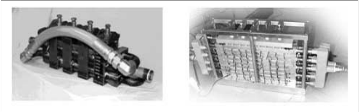
[그림 3] 열매순환식 적층형 열전발전모듈 개발 예 (좌) 100W급 적층식 열전발전유닛, Power Inc., (우)한국전기연구원에서 개발한 적층식 열전발전유닛
