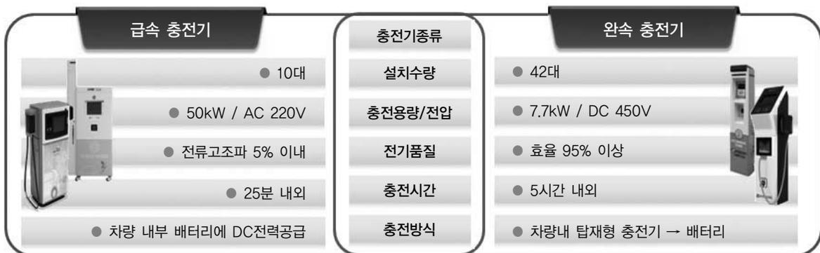
[그림 5] 충전기 주요사양
