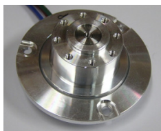
그림 5 유체동압베어링을 가지는 스피들 모터 Fig. 5 Spindle motor with fluid dynamic bearing
