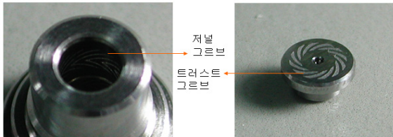
그림 4 그르브가 가공된 저널 및 트러스트 베어링 Fig. 4 Journal and trust bearings with grooves manufactured
