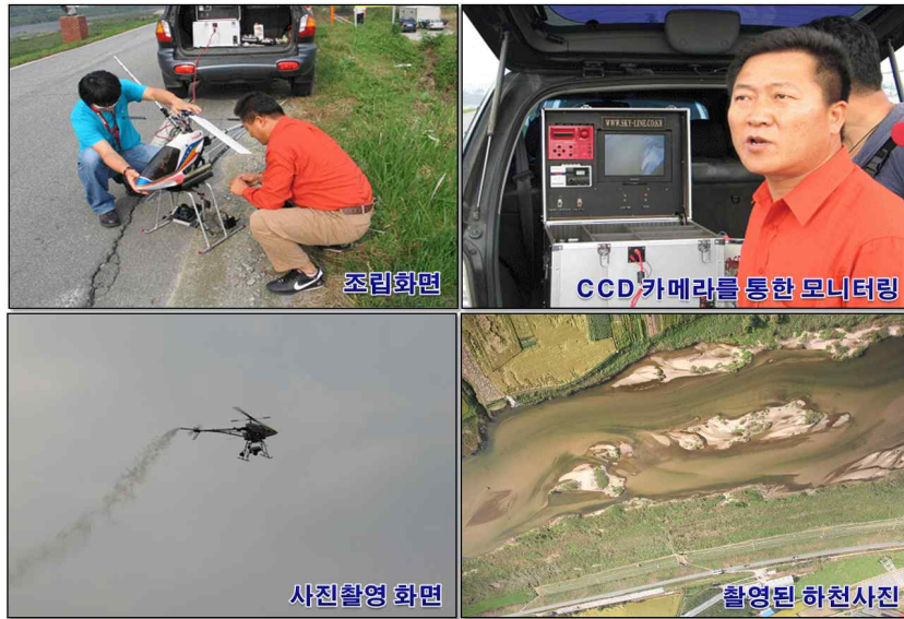
FIGURE 3. 무인항공기를 이용한 하천 사진촬영
