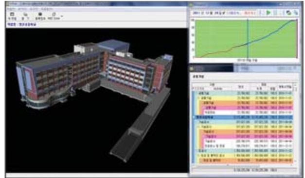
그림 4. 비용과 일정이 통합된 공정 Simulation
