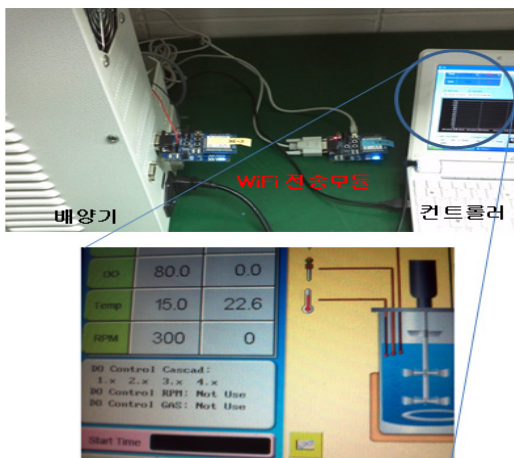
[그림 9] 광생물 반응기 무선 전송 실험 결과 [Fig. 9] Experimental result with LiPlus GX
