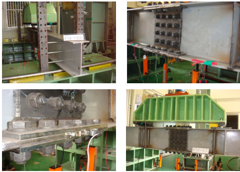
[그림 2] 휨시험편의 제작 [Fig. 2] Making of Bending Specimens
