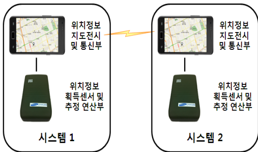
[그림 5] 위치정보 획득 및 공유 시스템 구성도 [Fig. 5] System configuration of position information acquisition and sharing
