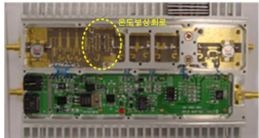
그림 3. 제작된 온도보상회로 검증용 증폭기 모듈 사진
