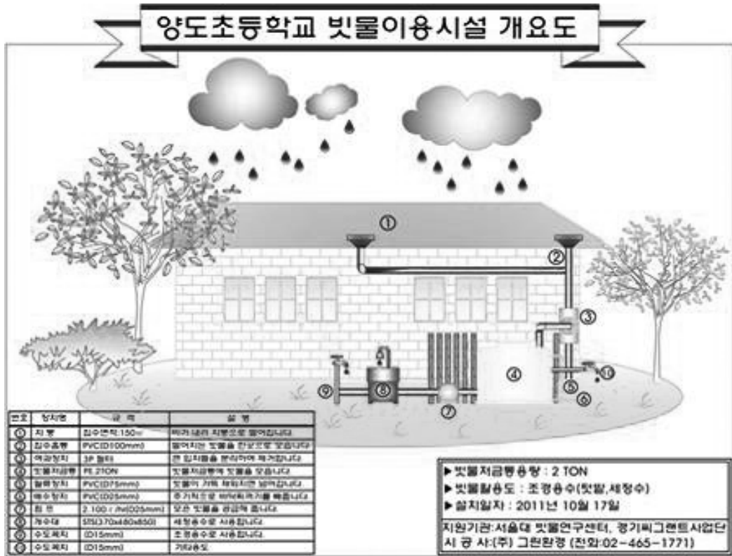
그림 3. 양도초등학교 빗물저금통의 개요도
